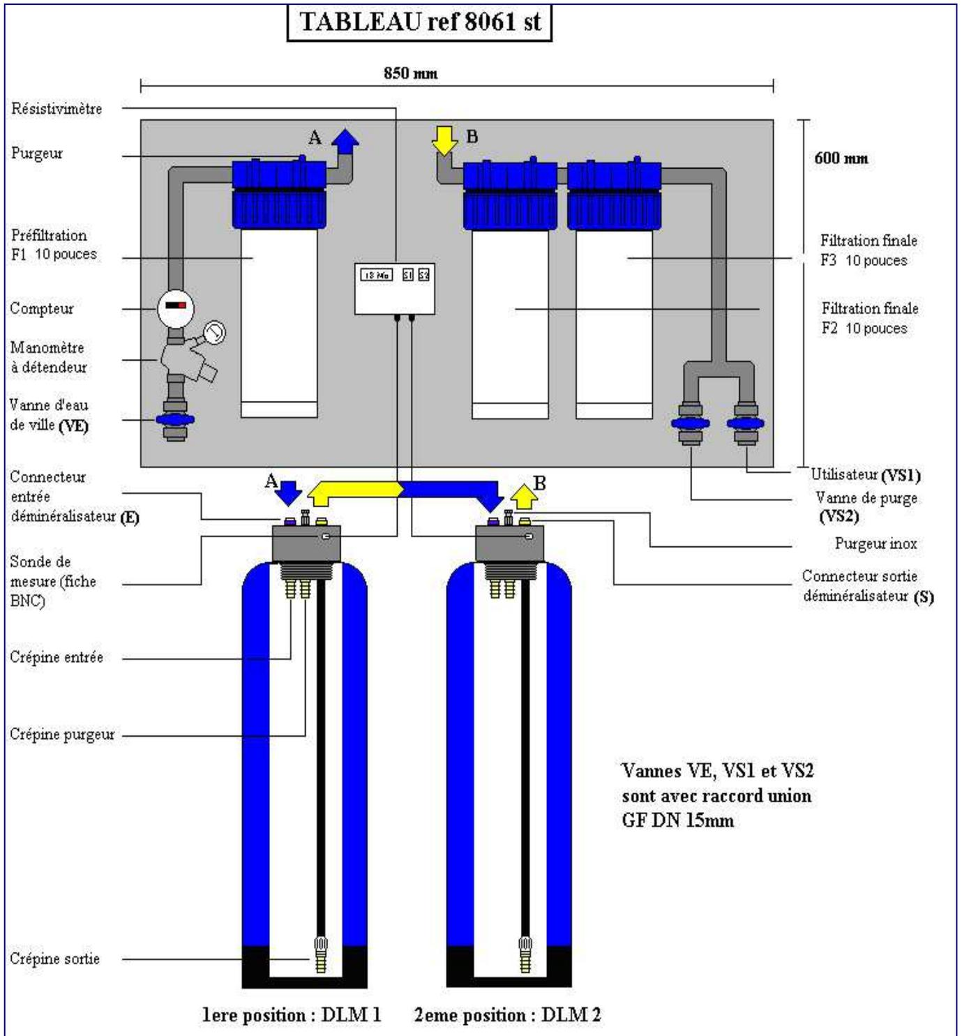
**1/ Avant tous raccordements sur notre installation, purger à l'égout la canalisation d'eau froide servant à alimenter l'installation jusqu'à ce que l'eau coule claire afin d'éviter le colmatage des filtres dû aux dépôts dans la canalisation**
